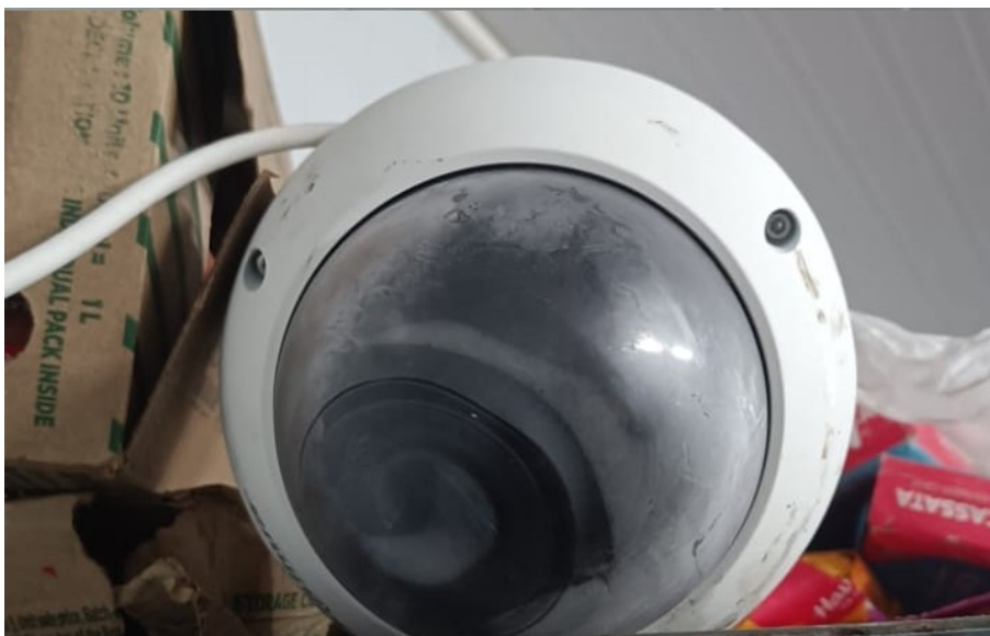
Obrázek 1-7 Vlhkost na povrchu
